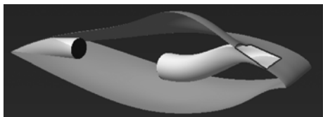
图 3 带有进排气系统计算模型示意图
